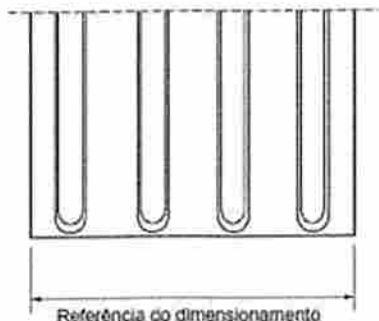
Figura 6 – Referência de dimensionamento do piso tátil direcional
