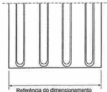
Figura 6 – Referência de dimensionamento do piso tátil direcional
